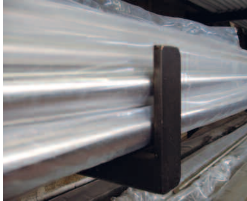
Kunststoffverpackungen verhindern, dass die Lagereinrichtungen Fremdeisenpartikel auf den nichtrostenden Stahl übertragen.
