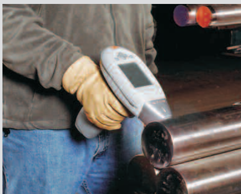
Auf tragbaren Analyseräten lässt sich die chemische Zusammensetzung der untersuchten Legierung ablesen.
