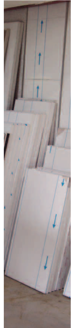
Die Schleif- bzw. Walzrichtung ist in der Regel auf den abziehbaren Schutzfolien angegeben
